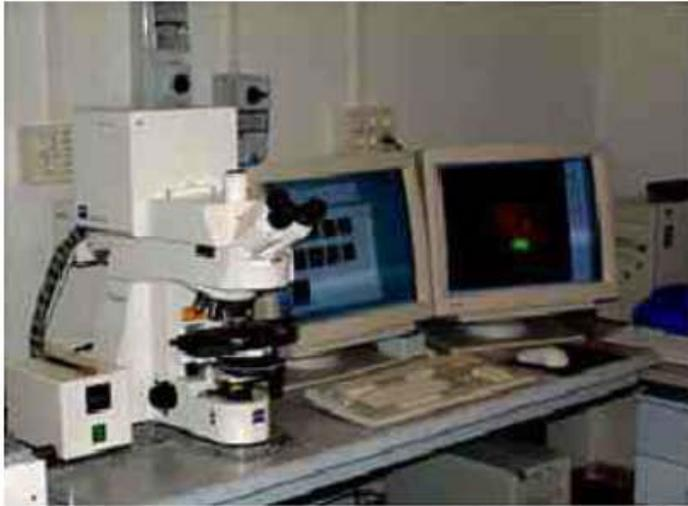
La microscopia confocale utilizza un raggio laser per illuminare un singolo piano del campione alla volta
