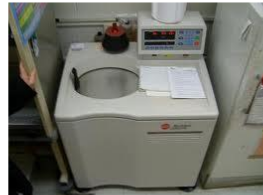
Le ultracentrifughe moderne raggiungono la velocità di 100 000 giri al min (rpm)
